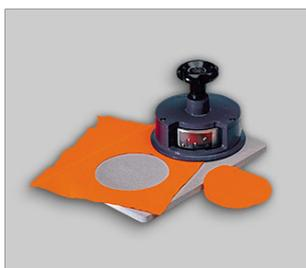
Coupe-Eprouvettes pour la coupe d'échantillons de 100 cm<sup>2</sup>, pour les placer sur les bascules de surface. Coupe très propre par des lames guidées en rotation et par coupe à traction. Avec 4 lames ajustables et interchangeables, avec plaque de protection en caoutchouc mousse.
