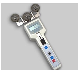
**Tensiómetro para fibras técnicas DTFX****Modelo: 9853/1****Preço a pedido !**
