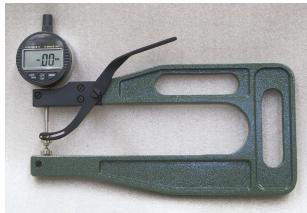
Medidor de Espessura DMD 820 V
