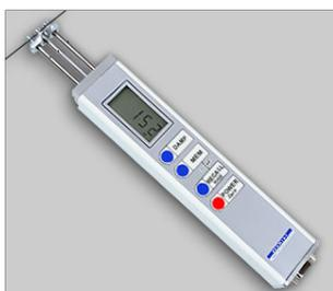
**Tensiomètre électronique ETM**
